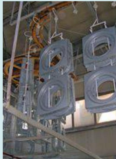
Mit „Interlox 5705“ beschichtete Waschmaschinenkomponenten vor dem Pulvern.
